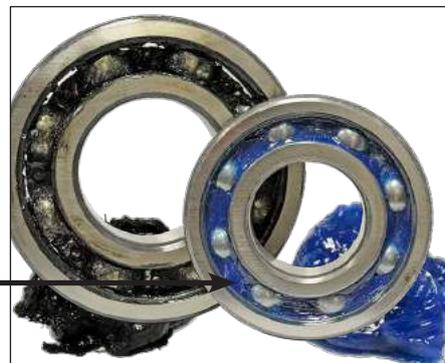
**4. Reinigen Sie die Lagerkomponenten** mit einem Entfettungs- oder Lösemittel.
