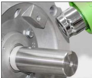
Colloidal Silver Shaft Coating (CS015) wird für alle Anwendungen empfohlen (wir empfehlen, kein Substitut einzusetzen). Die Silberbeschichtung erhöht die Leitfähigkeit der Welle und reduziert mögliche Korrosion, die den Übergangswiderstand erhöhen kann.
