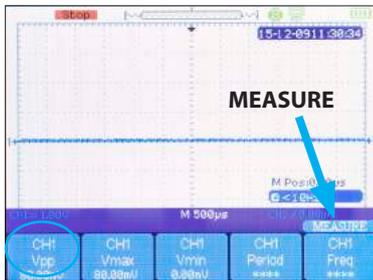
Drücken Sie auf **CURSOR|MEASURE**, bis das Menü **MEASURE** angezeigt wird. Wenn Vss über F1 aufgeführt wird, überspringen Sie die restlichen Schritte dieses Abschnitts.
