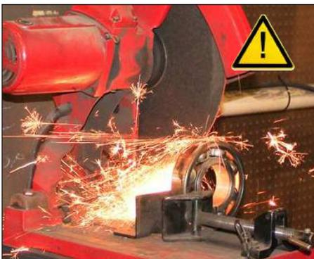
**2. Trennen Sie den äußeren Lagerring** in zwei Hälften. Entfernen Sie vor der Trennung alle Deck- oder Dichtscheiben.
