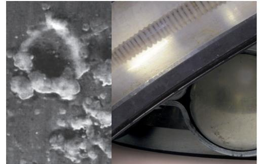
Verhinderung von Lagerschäden durch Stromdurchgang
