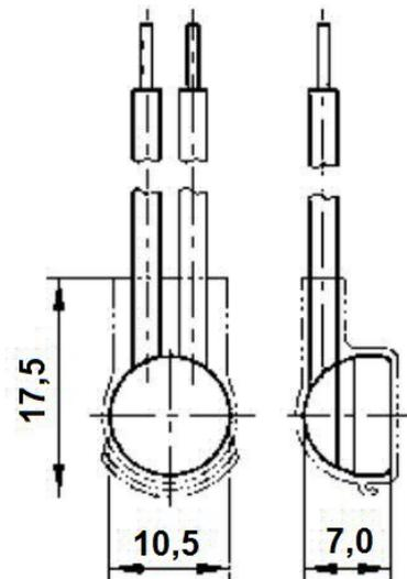
**Zuleitungsquerschnitt:** 0,75 mm<sup>2</sup>
