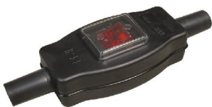
684 2-poliger Schnur-Zwischenschalter, IP44 Schaltleistung: 16 (4) A, 250 Vac Ausschalter, für Geräte der Schutzklasse I + II Schutzart: Spritzwasser geschützt Maße LxBxH: 97 x 52 x 30 mm
