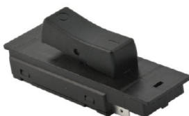
685 2-poliger Werkzeugzeugschalter/Wippschalter Buchsenklemmen M4 1257.5102 geeignet für Geräte der Schutzklasse II Schaltleistung: 16 (16) A 250 V AC 5E4, 23 (23) A 127 V AC 5E4 Schutzart Anschluss + Betätiger: IP40
