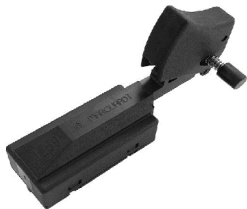
681 2-poliger Werkzeugschalter Schließer (DPNO) 1269.0201 Schraubanschluss M3,5 Schaltleistung: 12.5 (12.5) A 250 V AC 5E4 Schutzart Anschluss + Betätiger: Staubschutz Ersatz für: 1274.0201
