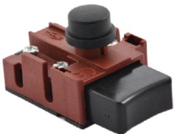
623 2-poliger Werkzeugschalter 4 Schraubanschlüsse LAA65331 Schalttaste mit Arretierung Schließer Schaltleistung: 6 A 250 V AC
